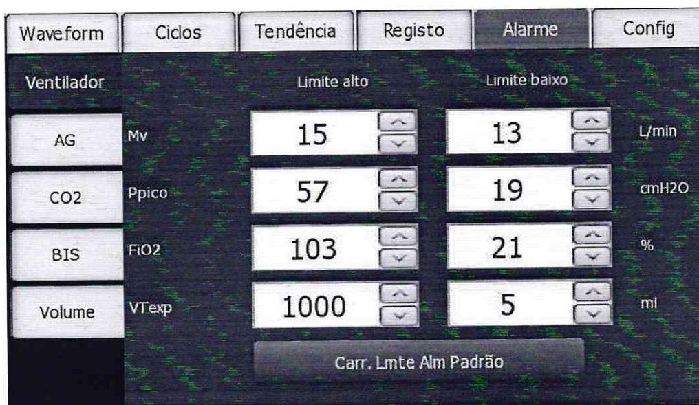
Fig. 6-1 Ajuste dos alarmes do ventilador
